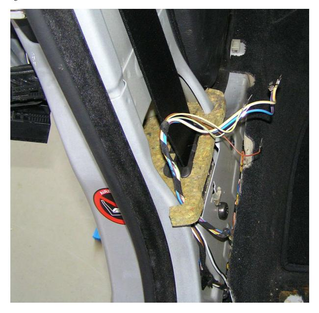
Nun ist der Türstecker zu demontieren. Dazu die hintere Türe schließen, und die Befestigungsschraube des Steckers (8er Nuss) von vorne entfernen, Türstecker leicht nach oben drücken und vorsichtig rausziehen. Verbindung zur Türe trennen, blaue Pinverriegelung entfernen und Pins nach Schaltplan einpinnen.
