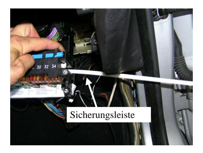
Anschließend das +-Kabel in Steckplatz F71 einschieben bis es verrastet. Da ist ein bischen Geduld gefragt. Ist eine ziemliche Fummelei.
