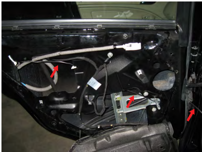
Türverkleidung hinten. Regenschutzabdeckung lösen. Kabel so verlegen, dass die Scheibe beim rauf und runter fahren nicht behindert wird.
