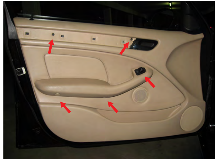
Türverkleidung vorne 5 Schrauben lösen, ringsum ausklipsen und alle Kabel rausziehen.
