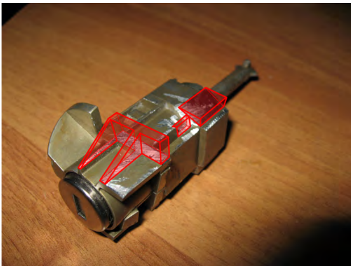
jetzt kommen wir zum Schloßzylinder. Diese müssen alle bearbeitet werden. Alles was rot Markiert ist, muss weg. Sonst bekommt man die Kabel nicht in den Innenraum.
