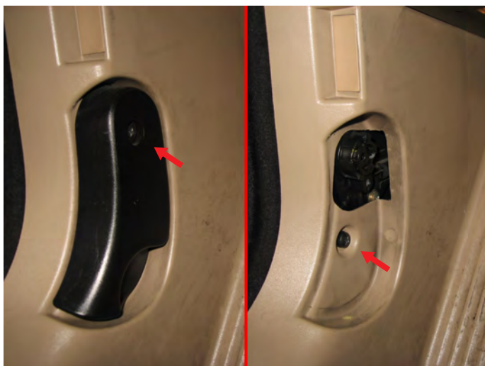
hier die 2 Schrauben von der Fußstütze lösen
