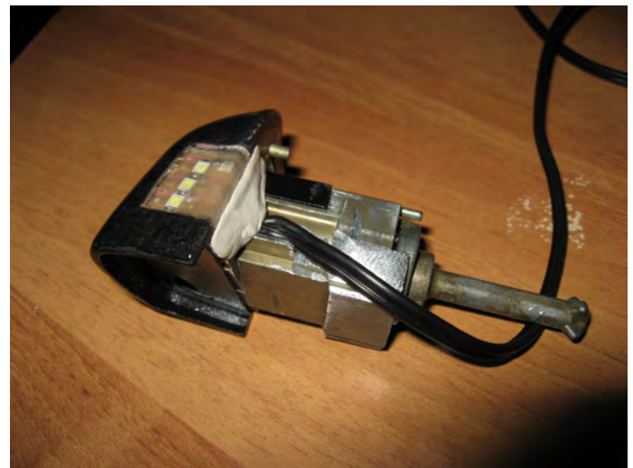
die Platine habe ich von unten mit einem Dichtband an den Schloßzylinder festgemacht und dann von oben mit 5min. Epoxy Harz übergossen. Und anschließen, damit alles schön dicht bleibt, mit bisschen Dichtmasse zugestopft :-)
