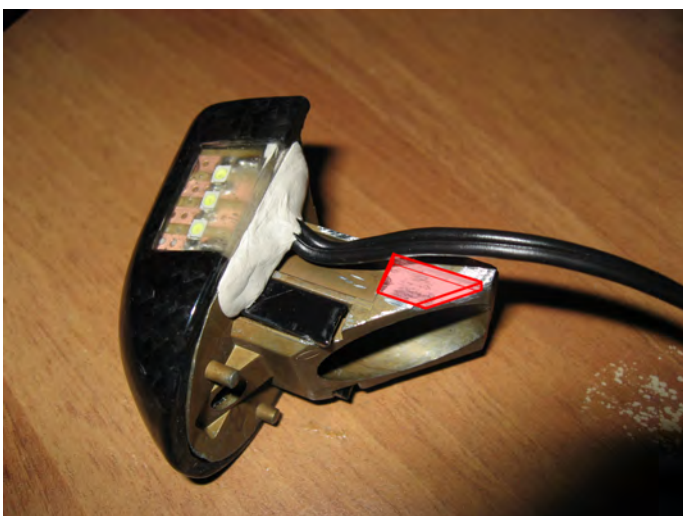
so sehen die Metallteile der hinteren Türen aus. also 3 SMDs reichen vollkommen aus :-) Auch hier, was rot ist, wegschleifen.
